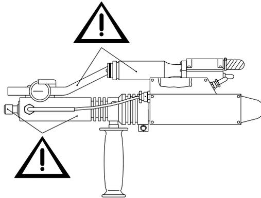
Achten Sie darauf, dass sich im Bereich vor der Luftvorwärmdüse keine leicht entzündbaren oder explosionsgefährdeten Materialien befinden.
