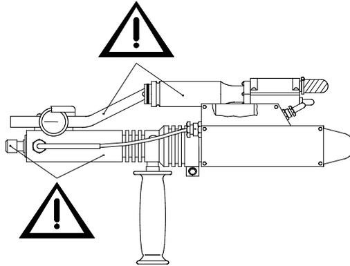
Achten Sie darauf, dass sich im Bereich vor der Luftvorwärmdüse keine leicht entzündbaren oder explosionsgefährdeten Materialien befinden.
