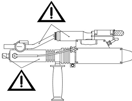
Achten Sie darauf, daß sich im Bereich vor der Luftvorwärmdüse keine leicht entzündbaren oder explosionsgefährdeten Materialien befinden.
